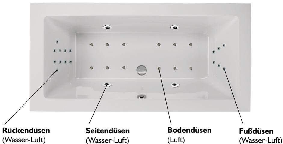
Für den Betrieb des Wassersystems wird eine Whirlpumpe verwendet. Das Badewasser wird angesaugt, mit Zuluft versehen und dann als Massagestrahl wieder durch die Düsen ausgestoßen. Man hat hier quasi einen Kreislauf. Ein Whirlsystem mit vielen Wasserdüsen sollte eine stärkere Pumpe haben als ein Whirlsystem mit wenig Wasserdüsen. Ansonsten fehlt die Massagewirkung oder der Massagestrahl ist zu stark und das Wasser spritzt über.
